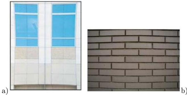
Figura 1.17: Aberración de distorsión. a) distorsión de corsé. b) distorsión de barril
