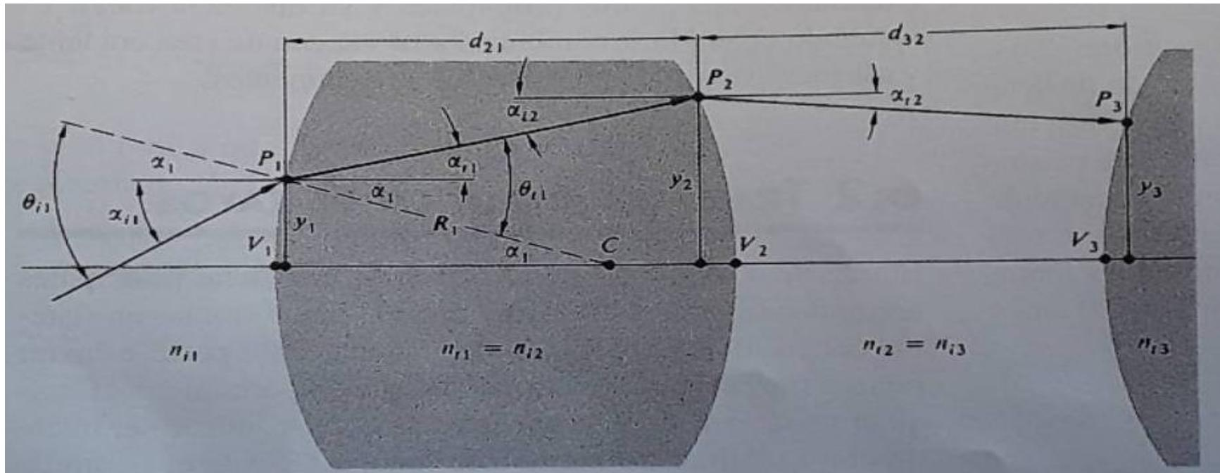
**Traslación** → **T**: caracterizamos la propagación en línea recta (el rayo viaja en el mismo medio sin interactuar Tramo  $\overline{OP}$  o al ir desde P1 a P2 dentro de la lente, ver Fig gris)
