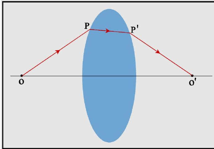
El objetivo es sistematizar el trazado de los rayos a medida que estos son "transformados" al llegar a la interface entre medios con diferentes índices de refracción o a medida que se trasladan en línea recta o se reflejan
