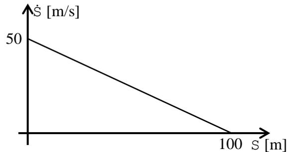
a) Obtener una expresión para su posición en función del tiempo y verificar que se requiere un tiempo infinito para que la partícula recorra los 100 m a que se hace referencia en la figura
