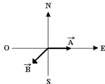
**PROBLEMA 33:** El coche A está tomando una curva de 60 m de radio con velocidad constante de 48 km/h. Cuando A pasa por la posición indicada en la figura, el automóvil B, que se encuentra a 30 m del cruce, se desplaza a una velocidad de 30 km/h acelerando hacia el sur a razón de  $1,2 \text{ m/seg}^2$ .
