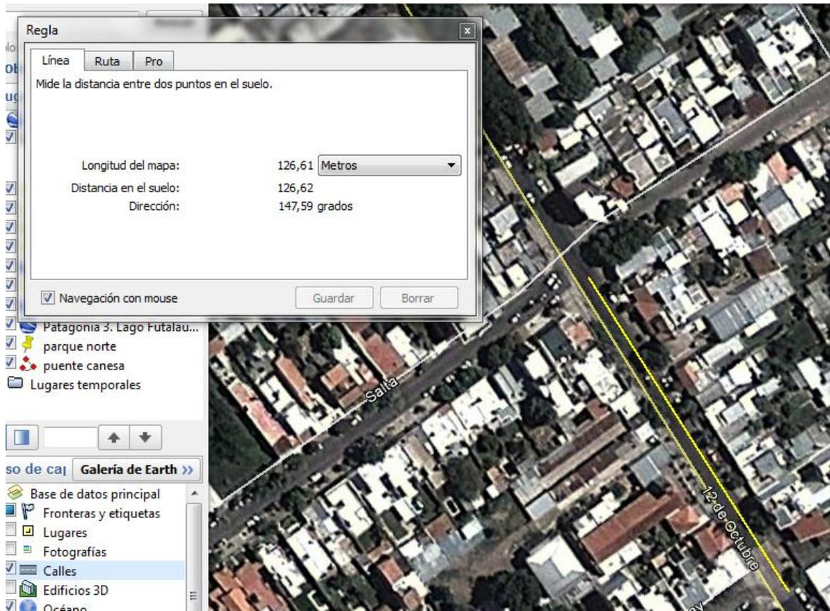
Aquí debemos recordar lo que vimos en la teoría de errores. El error nominal del instrumento va a ser la mínima unidad que podamos medir. No se confundan con la precisión que ven en pantalla. Con la escala que estamos usando en las imágenes, cada pixel representa alrededor de 0,3 mts. Además de éste error, es necesario hacer un cálculo estadístico. Para ello, midan por lo menos 5 veces las distancias ya que un leve cambio en la dirección de la línea representa un cambio longitud.
