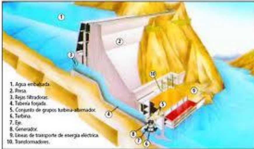
CORTE DE UNA CENTRAL HIDROELÉCTRICA
