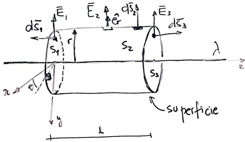
$$\Phi_{\vec{E}} = \oiint \vec{E} \cdot d\vec{s} = \iint_{S_1} \vec{E}_1 \cdot d\vec{s}_1 + \iint_{S_2} \vec{E}_2 \cdot d\vec{s}_2 + \iint_{S_3} \vec{E}_3 \cdot d\vec{s}_3$$
