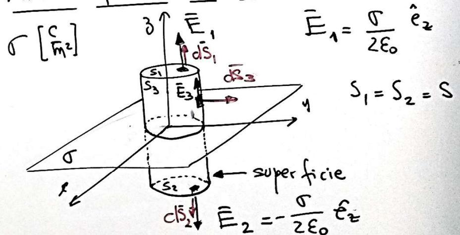
$$\Phi_{\vec{E}} = \oiint \vec{E} \cdot d\vec{s} = \iint_{S_1} \vec{E}_1 \cdot d\vec{s}_1 + \iint_{S_2} \vec{E}_2 \cdot d\vec{s}_2 + \iint_{S_3} \vec{E}_3 \cdot d\vec{s}_3$$
