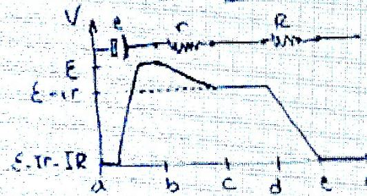
En la figura se ve la variación del potencial eléctrico a lo largo del circuito.
