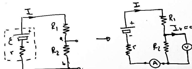
La resistencia interna del amperímetro debe ser pequeña, mientras que la resistencia del voltímetro debe ser muy grande,
