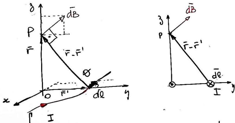
Las propiedades del campo magnético en el punto  $P$  debido a un elemento del cable  $d\vec{l}$  (fuente infinitesimal de corriente), resulta:
