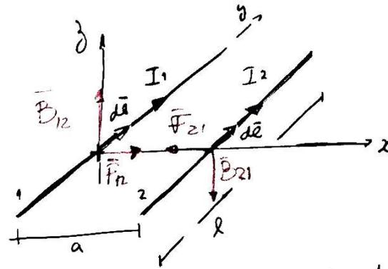
Existe una fuerza en el cable 1 debido a la corriente en el cable 2 y viceversa.
