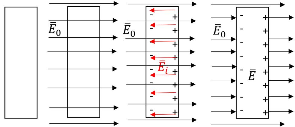
Una vez que se prende el campo eléctrico  $\vec{E}_0$ , se produce el movimiento de las cargas eléctricas en el interior del conductor eléctrico, de manera que se “induce” un campo eléctrico  $\vec{E}_i$  que se opone a  $\vec{E}_0$  de manera que en el interior  $\vec{E} = 0$ , es decir,
