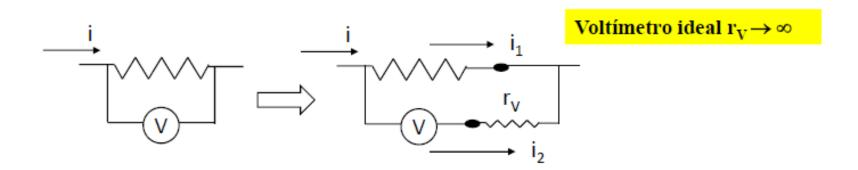
Voltímetro tiene resistencia interna rV => modifica circuito
