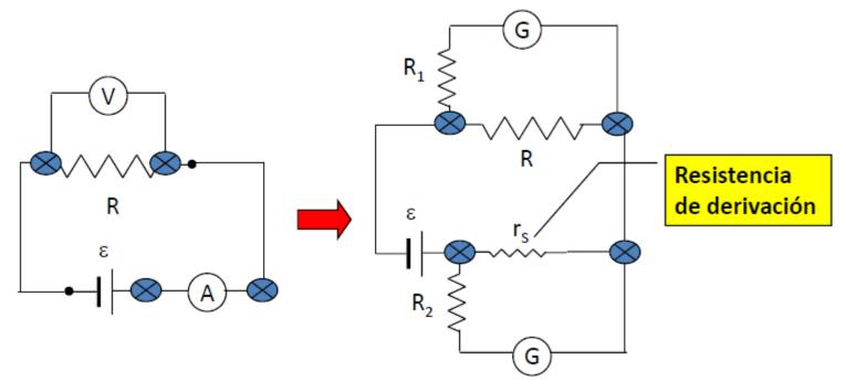
Galvanómetro: dispositivos en el que la corriente que circula por una espira produce una deflexión en la aguja del medidor proporcional a esa corriente (efecto magnético). Sencibilidad 10-8 A
