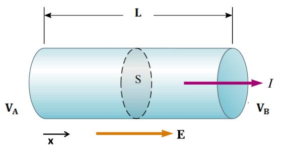
Aplicando la Ley de Ohm y la definición de corriente se llega a una expresión para la resistencia, R, del conductor rectilíneo.
