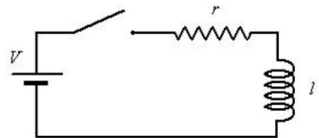
**Problema 28.** Se tiene un circuito en serie que consta de una bobina de inductancia L, una resistencia r y una batería de potencial V. Para un tiempo igual a la constante de tiempo, después de que se cierra el interruptor, encontrar lo siguiente:
