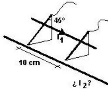
**Problema 19.** Una varilla metálica se mueve con una velocidad constante  $v = 2 \text{ i} \text{ m/s}$  paralelamente a un conductor recto que lleva una corriente de 40 A.
