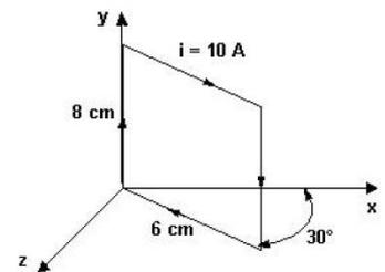
**Problema 6.** La espira rectangular de la figura tiene una masa por unidad de longitud de valor 0.1 g/cm y gira alrededor del eje z sin rozamiento. Por la espira circula una corriente de intensidad 10 A en el sentido indicado.
