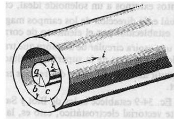
**Problema 15.** La figura muestra a un conductor cilíndrico hueco, cuyos radios son  $a$  y  $b$ , que transporta una corriente  $I$ , distribuida uniformemente en toda su sección transversal.
