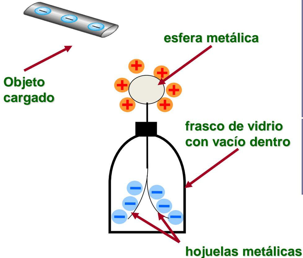
El electroscope es un instrumento muy sencillo que permite saber si en las proximidades hay un cuerpo cargado.
