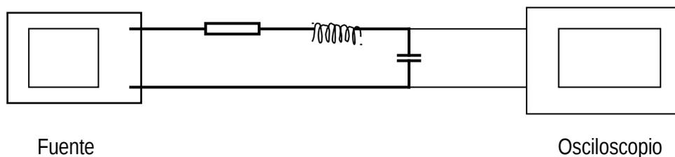
La frecuencia se determina midiendo el período sobre el eje de tiempo del osciloscopio, entre dos máximos consecutivos de la cosenoidal. Para determinar el amortiguamiento se mide la amplitud de la oscilación en los mismos máximos respecto a la tensión estacionaria, de manera que:
