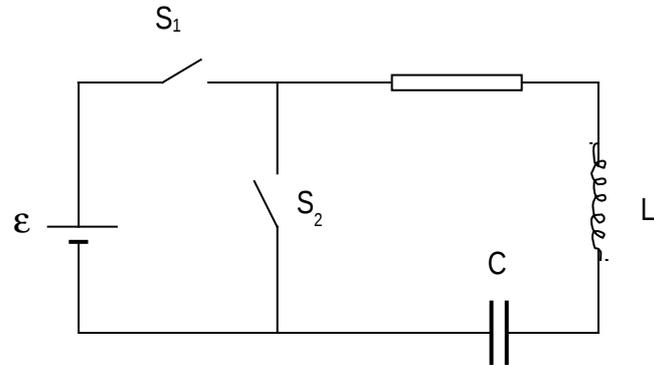
la primera condición, porque el capacitor está inicialmente descargado y la segunda, porque la corriente antes de cerrar el interruptor es nula y no puede cambiar instantáneamente (implicaría una tensión infinita en la inductancia, di/dt infinita). Con estas dos condiciones:
