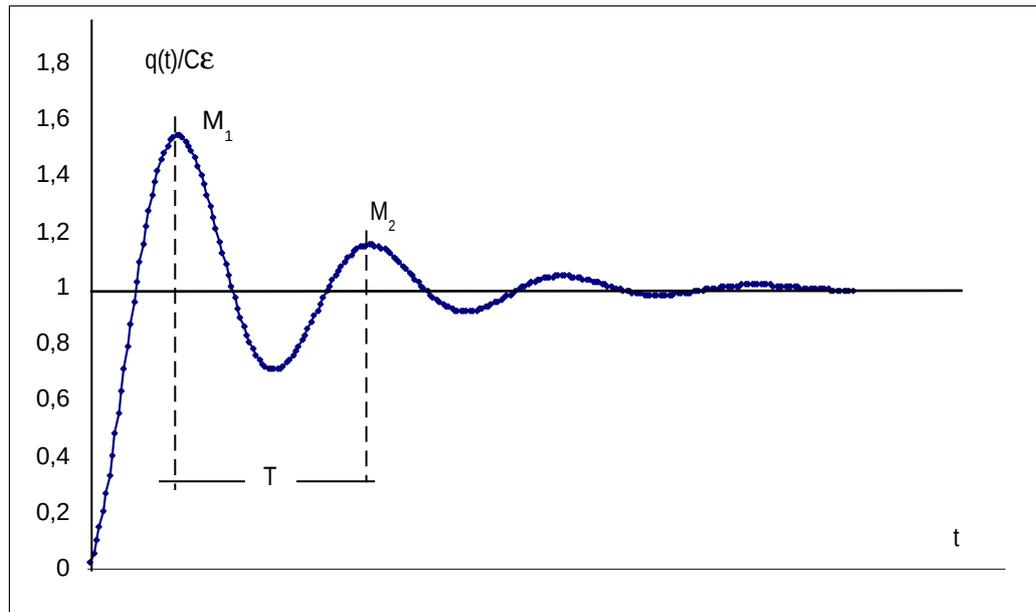
La tensión en el capacitor alcanza su valor estacionario siguiendo una oscilación cosenoidal amortiguada por una exponencial decreciente siendo  $\alpha$  el coeficiente de amortiguamiento. La frecuencia angular es  $\omega_d$ , menor que  $\omega_0$ . Esta última es la frecuencia con que oscilaría si la resistencia fuera nula ( $\alpha = 0$ ).
