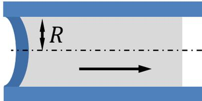
**7)** Un fluido Newtoniano y viscoso fluye entre dos cilindros, por efecto de un gradiente de presión constante.
