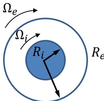
**9)** Considere un film de un fluido Newtoniano incompresible contenido en un recipiente cilíndrico. El cilindro se pone en movimiento con una dada velocidad angular.
