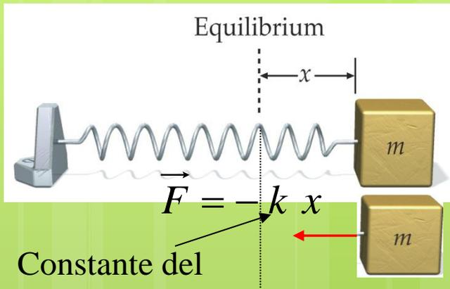
Podemos visualizar el MAS analizando el movimiento del bloque bajo la acción de un resorte
