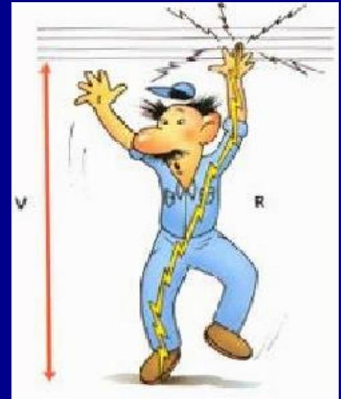
**Si el sujeto está en contacto con otro elemento conectado a tierra, la resistencia baja.**
