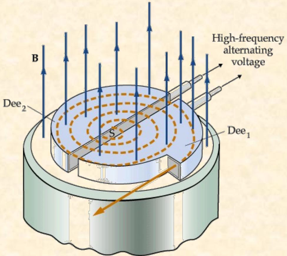
Las partículas cargadas procedentes de la fuente  $S$  son aceleradas por la diferencia de potencial existente entre las dos "des". Cuando llegan de nuevo al hueco, la ddp ha cambiado de signo y vuelven a acelerarse describiendo un círculo mayor. Esta ddp alterna su signo con el periodo de ciclotrón de la partícula, que es independiente del radio de la circunferencia descrita.
