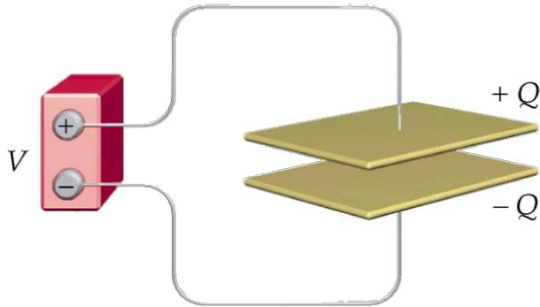
De esta forma, los portadores de carga se mueven de una placa a otra hasta que se alcanza el equilibrio Electrostático. Así, la diferencia de Potencial entre las placas es la misma que entre los terminales de la batería.
