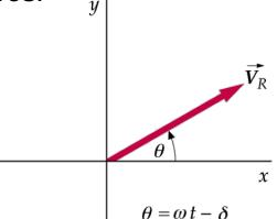
Podemos representar la caída de potencial en una resistencia como un vector de módulo  $I_oR$ , que forma un ángulo  $\theta$  con el eje X
