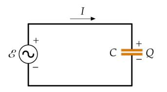
Para calcular la corriente en el circuito aplicamos la L.K.V
