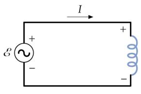
Para calcular la corriente en el circuito aplicamos la L.K.V
