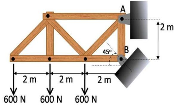
**Problema 14.** Determinar las reacciones en el perno A y la reacción en el apoyo simple B. Sobre la viga actúan tres fuerzas de igual módulo tal como se muestran en la figura.
