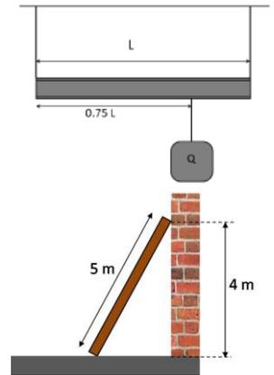
**Problema 8.** Una escalera de 5m de longitud está apoyada contra una pared en un punto a 4m por arriba del piso de cemento, como se muestra en la figura. La escalera es uniforme y tiene una masa  $m = 12$  kg. Suponiendo que la pared no tiene fricción (pero el piso sí la tiene), determinar las fuerzas ejercidas sobre la escalera por el piso y por la pared.
