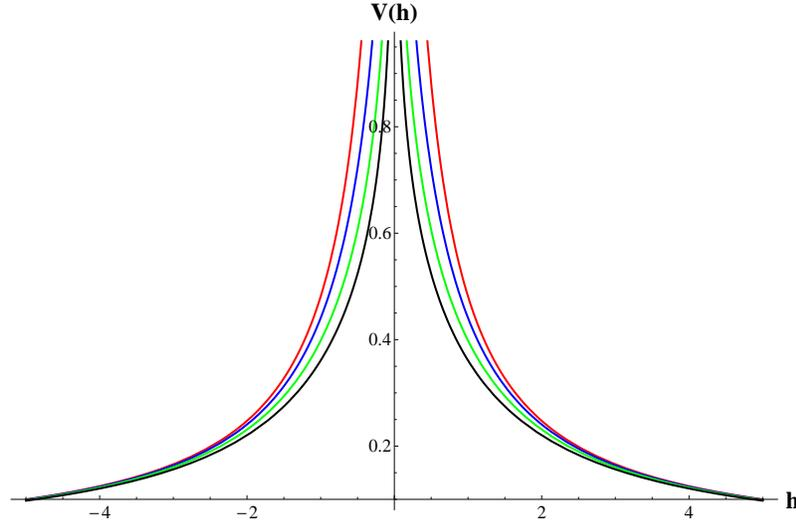
Figure 4: Potencial electrico de una densidad de carga lineal uniforme para diferentes valores de  $l$ .
