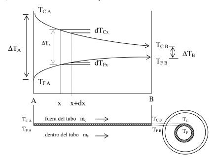
Para una longitud infinitesimal, asumiendo U = cte, la velocidad de transferencia de calor desde el fluido de afuera al de adentro del tubo es
