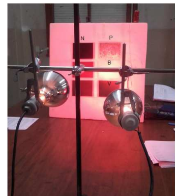
Fotografía que muestra la disposición de los elementos utilizados para la medición con luz infrarroja
