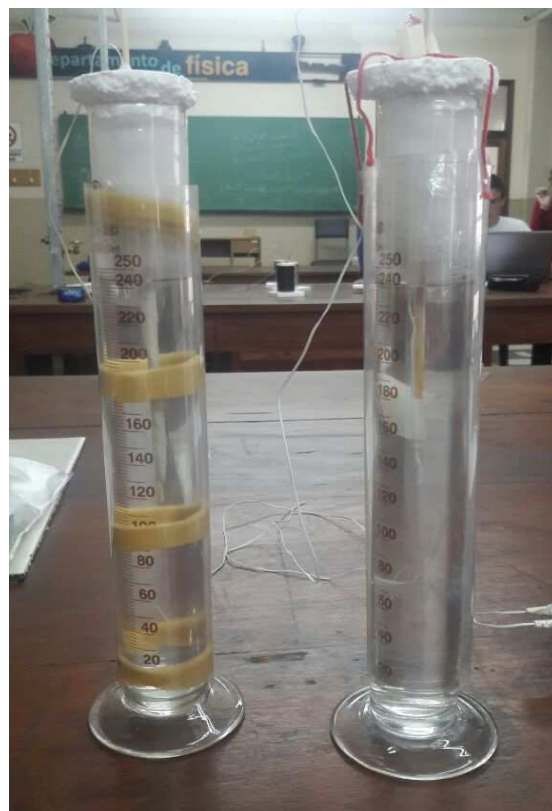
Figura 1: Probeta de la izquierda sin circulación de aire. Probeta de la derecha con circulación de aire.
