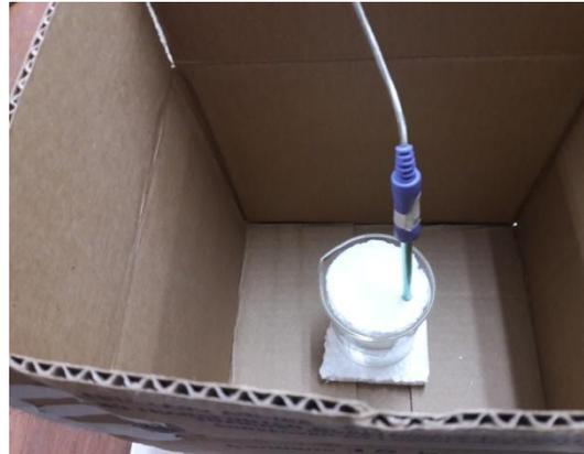
*Ilustración 2: Vista superior de sistema de convección natural.*
