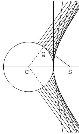
PARÁBOLA. Dibujamos una recta cualquiera  $L$  y un punto  $S$  no situado en ella. Desde cualquier punto  $Q$  de la recta trazamos la perpendicular a  $SQ$ . Una cantidad suficiente de rectas así construidas envuelven a una parábola con foco en el punto  $S$ .
