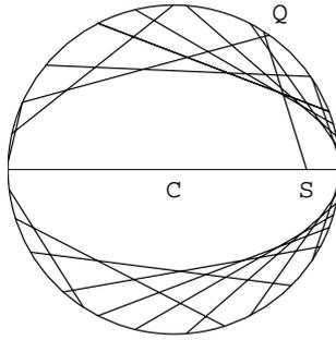
HIPÉRBOLA. Se dibuja un círculo de centro  $C$  y un punto  $S$  exterior a la circunferencia. Se traza la perpendicular a  $SQ$ , para cualquier punto  $Q$  de la circunferencia. La familia de rectas obtenida es la envolvente de una hipérbola. Las perpendiculares  $CA$  y  $CB$  a las rectas tangentes a la circunferencia que pasan por  $S$  son las asíntotas de la hipérbola, rectas a las que la hipérbola se acerca en el infinito.
