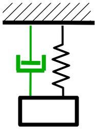
8. La amplitud de vibración de un sistema como el mostrado en la figura decrece un 25 % de su valor inicial después de 5 ciclos consecutivos. Determine el coeficiente de rozamiento  $c$  si el sistema posee un  $k = 20$  y  $m = 2$ .
