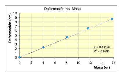
En la figura se muestra el resultado de aplicar el ajuste de mínimos cuadrados a los valores medidos de deformación de un resorte en función de la masa del cuerpo que pende del mismo. Los puntos son los datos experimentales y la línea es la recta de ajuste.
