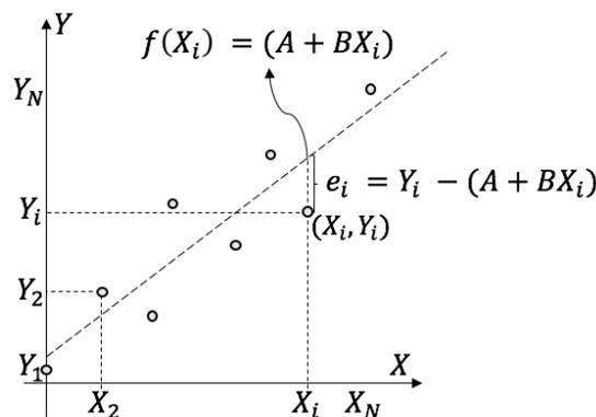
La desviación vertical entre cada punto experimental  $Y_i$  y el correspondiente valor de función de la recta  $f(X_i) = (A + B X_i)$  está indicada en el gráfico como  $e_i$ . De esta forma:
