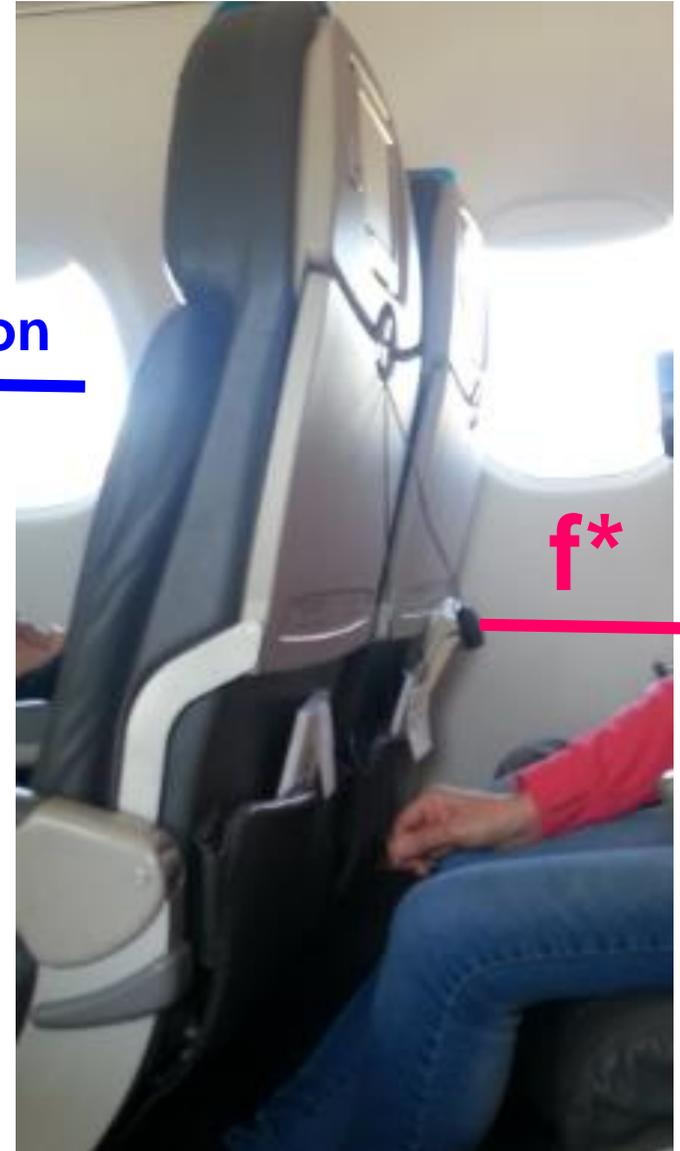
**Ejemplo 2** A partir del ángulo de inclinación del péndulo, estimar la aceleración del avión antes de despegar
