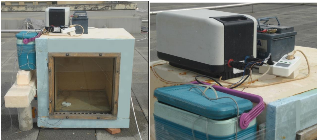
Fig. 7-31. Izquierda: fotografía general del ensayo. Derecha: detalle de los dos circuitos primario y secundario.
