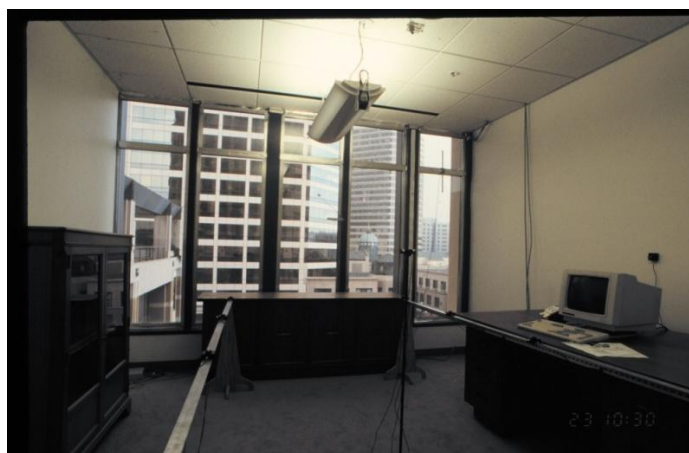
Fig. 2-55. Interior del prototipo ensayado, antes de que el sol entre por la ventana, el vidrio electrocrómico está en su estado más transparente. Fuente: LBNL
