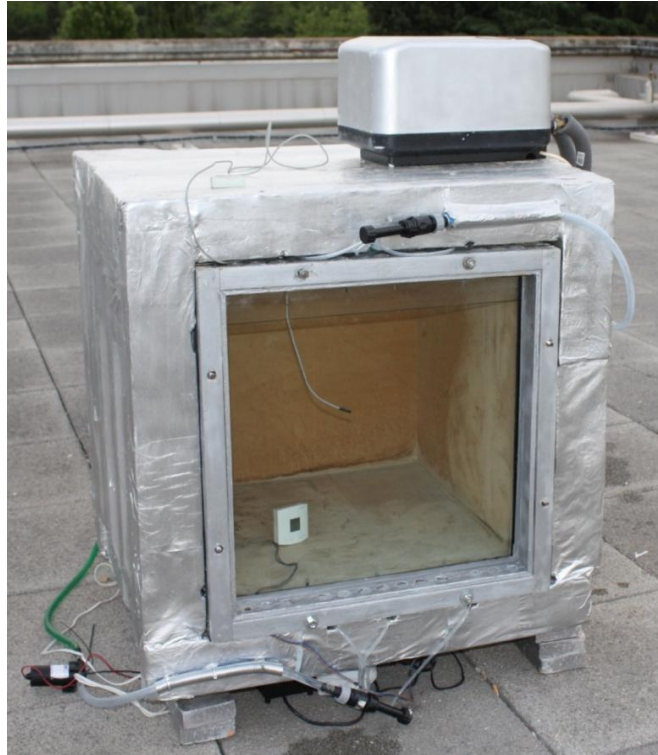
Fig. 7-36. Fotografía del procedimiento de ensayo donde se observan los conductos aislados.
