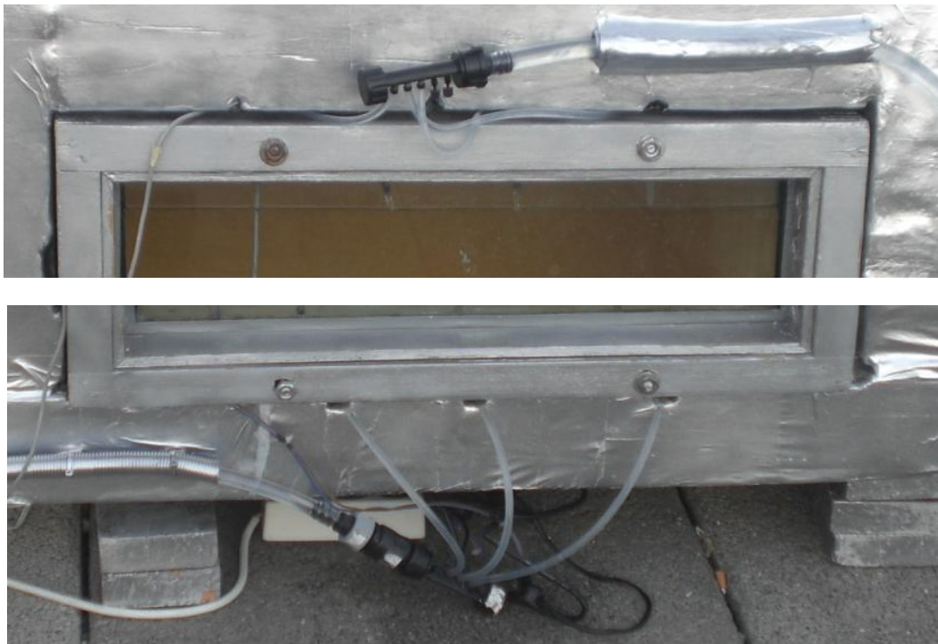
Fig. 7-22. Detalle del colector superior e inferior del vidrio con enganche de fácil apertura y cierre mostrando los tres conductos de 6x4mm.
