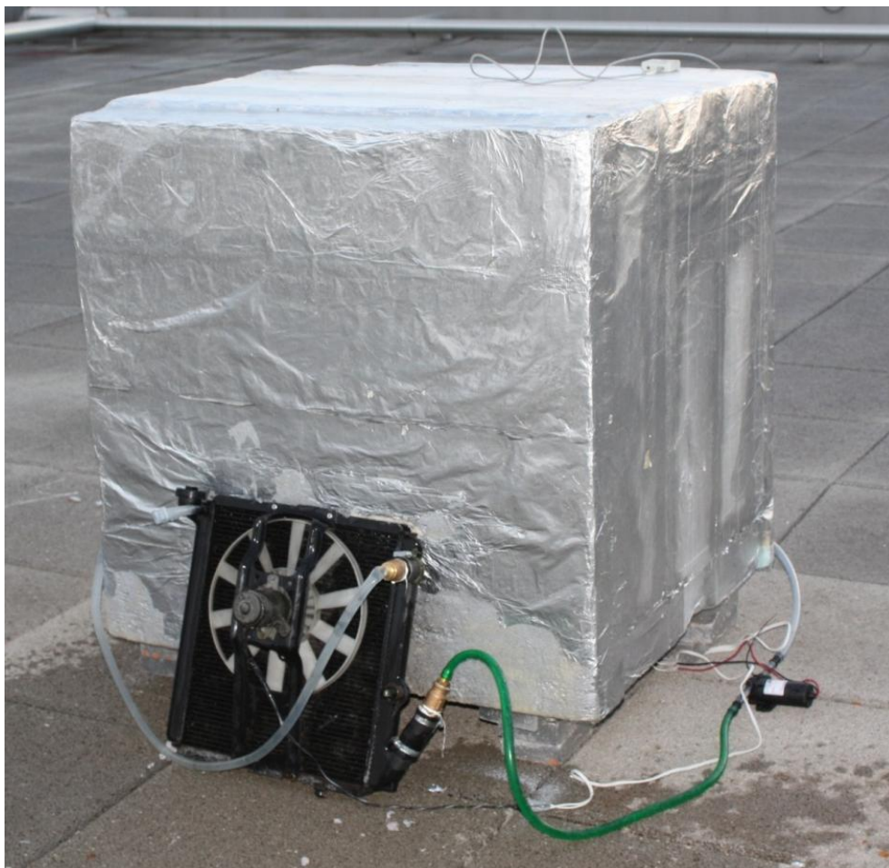
Fig. 7-23. Fotografía del funcionamiento del ensayo a pérdidas.
