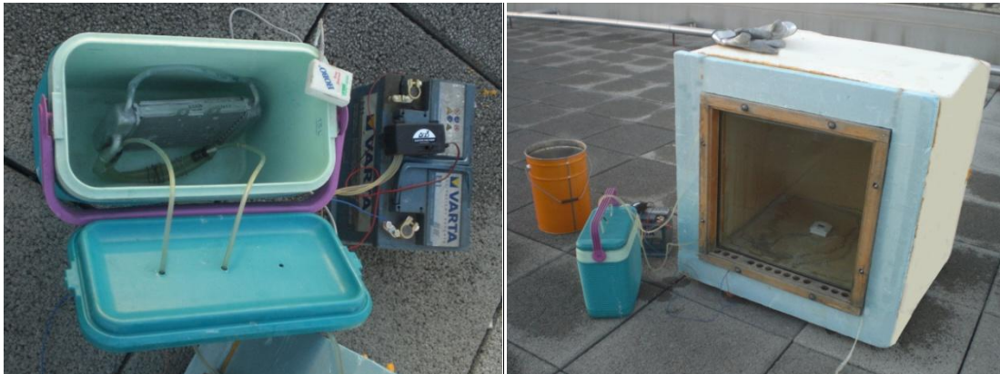
Fig. 7-29. Izquierda: vertido del agua caliente en el interior del depósito. Derecha. Ensayo final.
