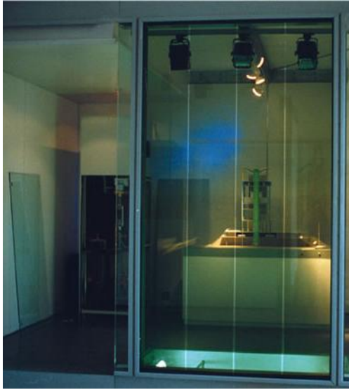
Fig. 2-59. Prototipo de acristalamiento con cámara de agua (1.5 x 2.6 m). Realizado por MFG&C y Vegla glassworks (Alemania). Architectural visions for Europe Exhibition , Norman Foster. Fuente: www.mckeefluidizedglazing.co.uk
