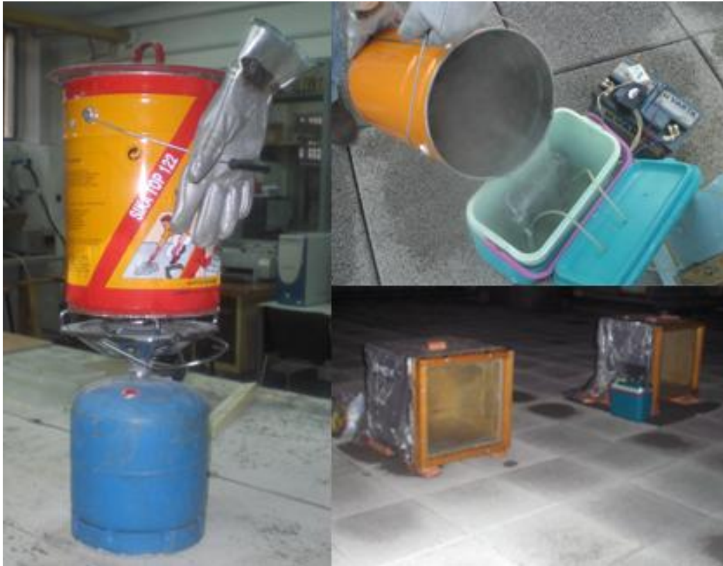
Fig. 7-26. Calentamiento del agua mediante una bombona de camping gas y posterior vertido del agua en el depósito.
