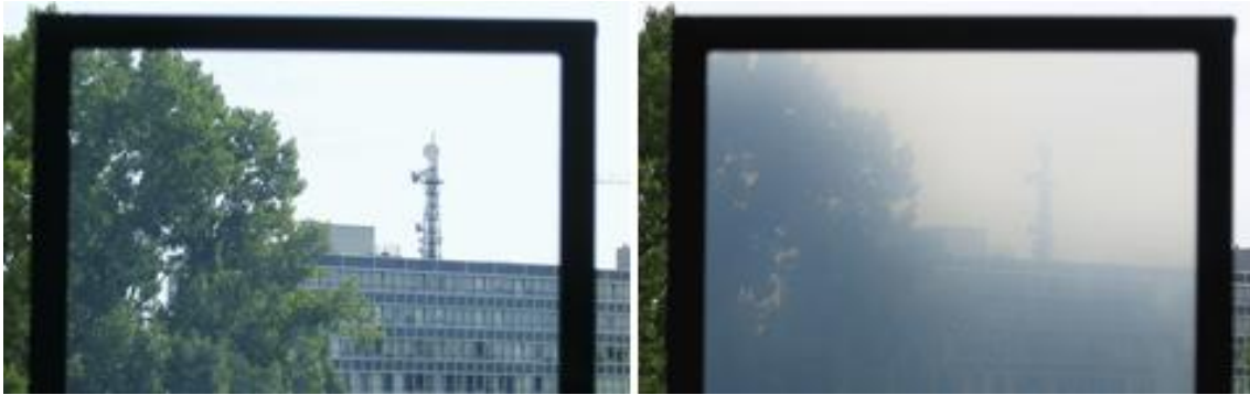
Fig.2-51. Demostración del cambio de opacidad de una ventana de 100*50 cm, a 20°C (transparente) y a 30°C (translúcido) al cambio de temperatura. Fraunhofer-Institut für Angewandte Polymerforschung. Fuente: Alexandra Raicu (2002).
