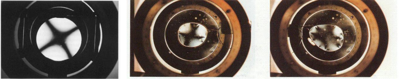
Sea un material transparente isótropo al que se le aplican tensiones mediante adecuados elementos externos. En la figura adjunta se muestran las tensiones inducidas en una lente oftálmica al ser montada: La lente se encuentra entre dos polarizadores cruzados.
