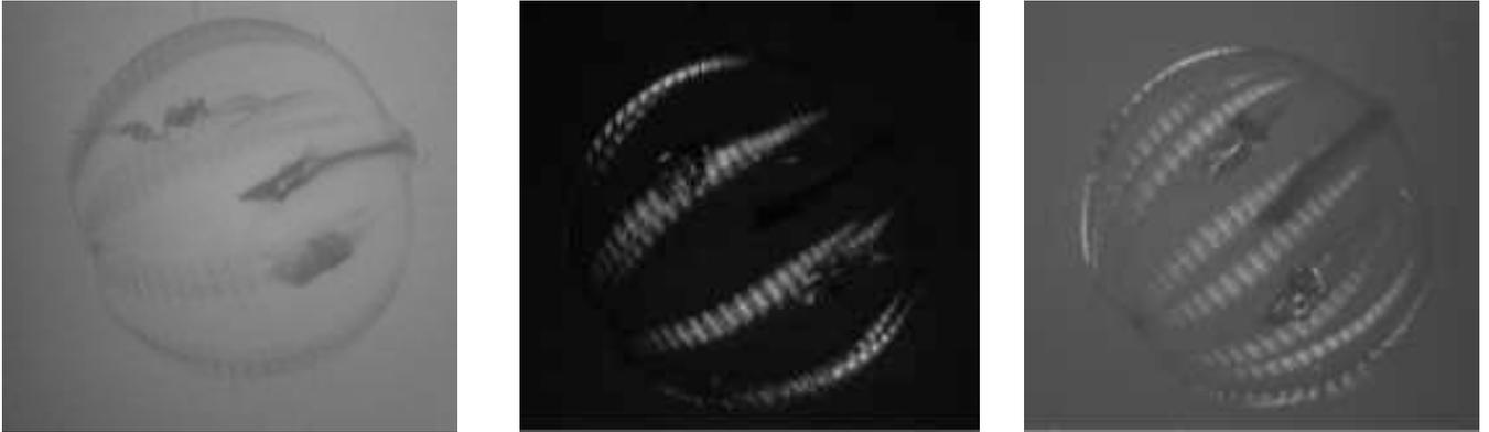
partes del objeto que de otra manera no se verían con iluminación convencional. En las fotografías de un tipo de placton marino se puede apreciar lo que decimos: La foto de la derecha se ha tomado con iluminación normal. Se mejora notablemente el contraste entre dos polarizadores cruzados, e incluso se ven estructuras procesando la imagen en un computador mezclando las polarizaciones de la luz reflejada.
